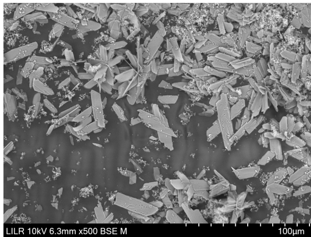
Figura 2.23 Imagen de microscopia electrónica de barrido de los cristales obtenidos después de la cinética a pH 6,5, para una concentración de 800 ppm de fósforo y 170 ppm de calcio. Se observó una gran cantidad de BRU con HAP minoritario.
